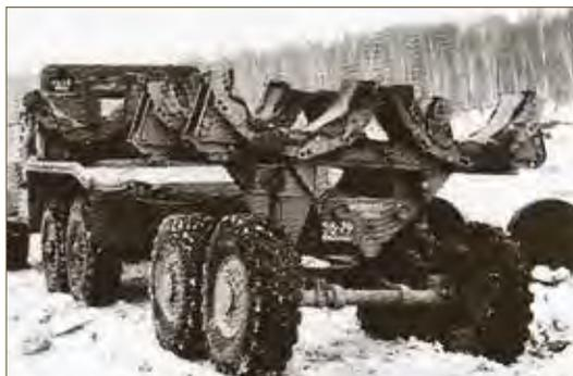
**Навесное оборудование к трубоплетевозу для перевозки труб с антикоррозионным покрытием.**
