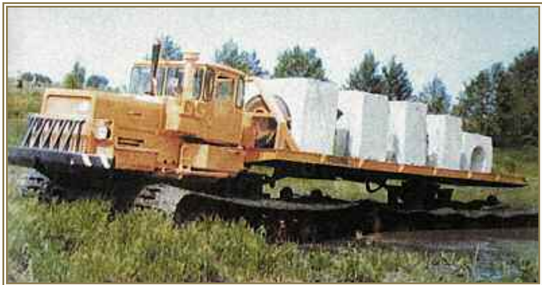
Болотоход по болотам доставляет пригрузки к трубопроводу
