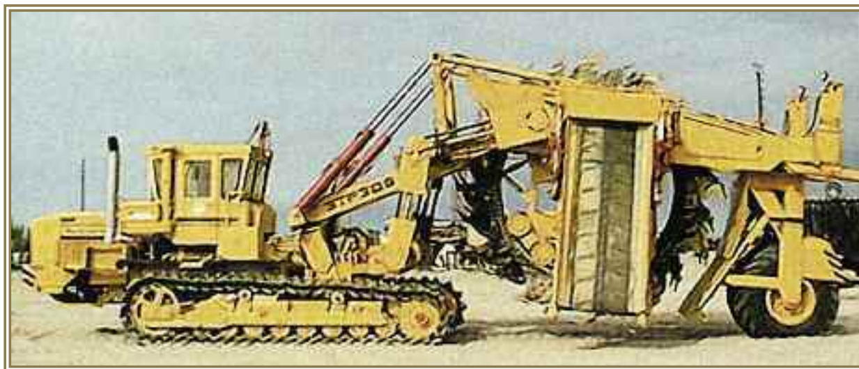
Роторный траншейный экскаватор ЭТР-309, 1989 г.
