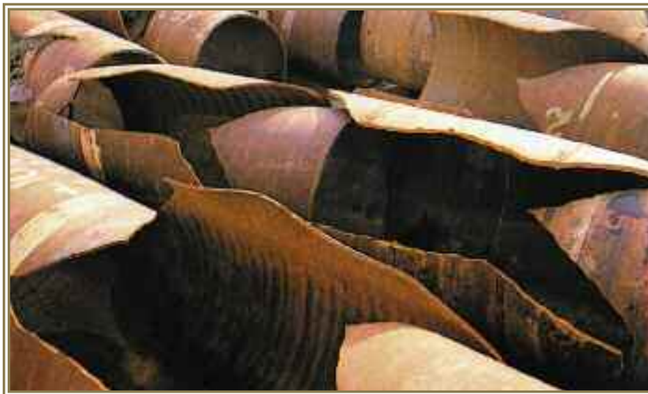
«Образцы труб», прошедшие испытания, ВНИИСТ
